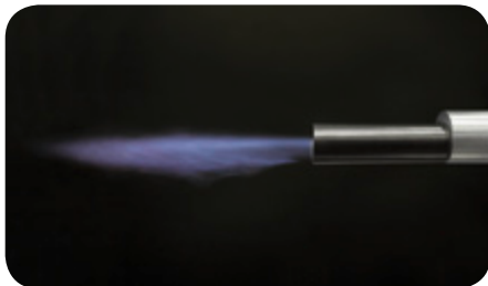
Flamme des ZKIH bei Erdgasbetrieb im Freibrand
