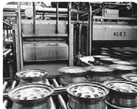
Aluminium-Industrie: Aushärtungsöfen für Felgen
