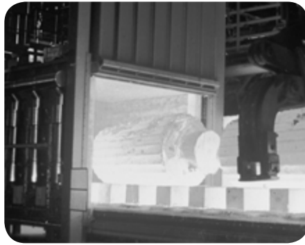
Wagenherd- Schmeldeofen in der Metallindustrie
